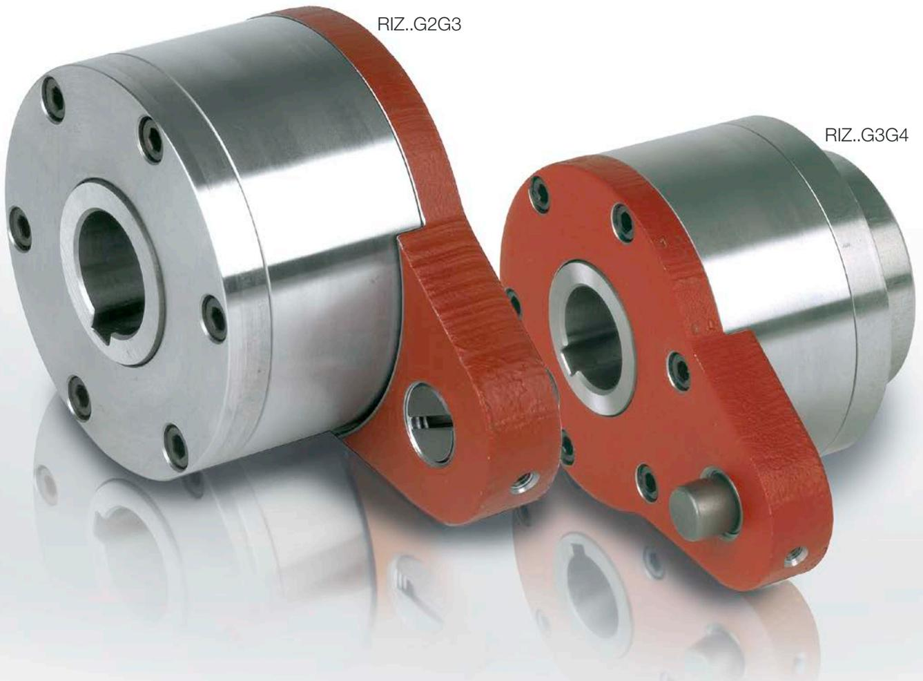
RIZ..G2G3/G3G4 型为离心式起飞制轮木型自由轮，内座圈转动。只有内部座圈适用于自由轮。
