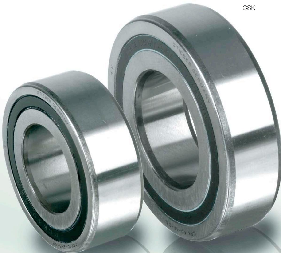
CSK 型式为不规则形状作动子单向离合器，外形尺寸与 62 系列轴承相同（尺寸 8 号和 40 号除外）。内含轴承支撑，油脂润滑，可防止 0.3 毫米以上的尘灰进入内部。若工作温度超过 50°C 时，推荐使用 "nylos" 型密封盖。也可选用油浸润滑。
