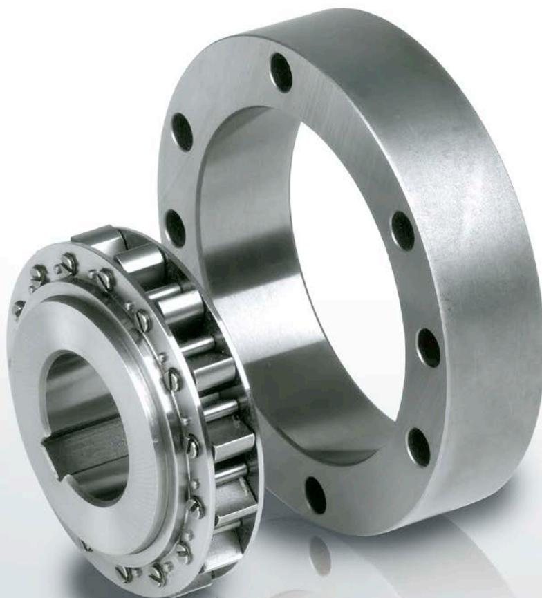
RSXM 系列是中小型止逆离合器系列中的最新一款，最早一款是取得巨大成功的 RSCI 程序。RSXM 型是一种离心式起飞制轮木型自由轮，内座圈转动。只有内部座圈适用于自由轮。这是一种非自支撑型。必须提供轴承，以确保内座圈与外座圈的同轴度以及支撑轴向与径向负载（如次页所示）。必须遵循同轴度与跳动限值。
