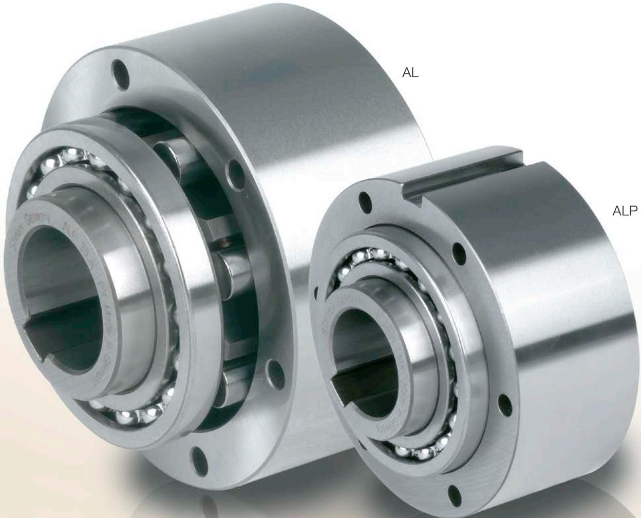
AL 与 ALP 型是滚轴式自由轮。这些装置属于 Stieber 模块化系统的组成部分。它们由两个 160.. 系列轴承支撑，需要使用润滑油润滑。这些装置可在提供润滑油润滑与密封功能的设计中使用（如次页示例所示）。
