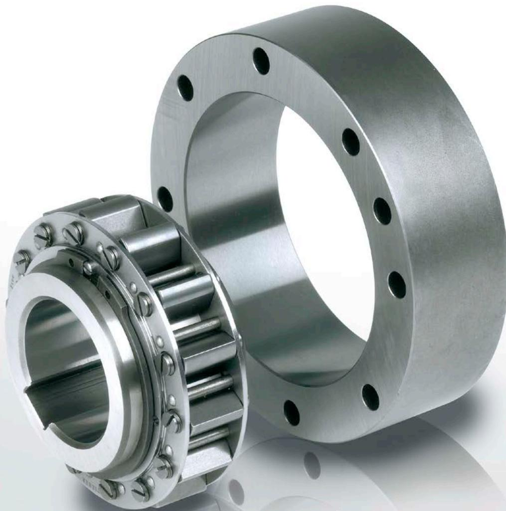
**R**SCI 是离心力拉起作动子,带内环旋转的单向离合器。内环只是为单向转动而设计。上的超越离合器。定位环面绝不可接触到作动子保持器。请参阅 Stieber 详细样本第 74 页 (RSCI 20-300) 的更多信息。
