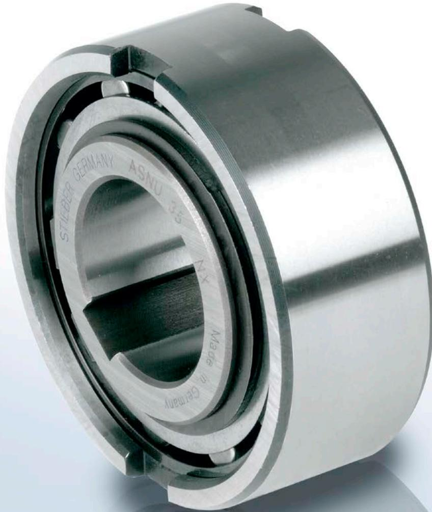
**A**SNU 型号为滚柱型单向离合器无轴承支撑。ASNU 型号需要配合轴承安装以支撑轴向和径向负载。使用者需提供润滑及外部的密封。外形尺寸与 63 系列滚珠轴承相同。
