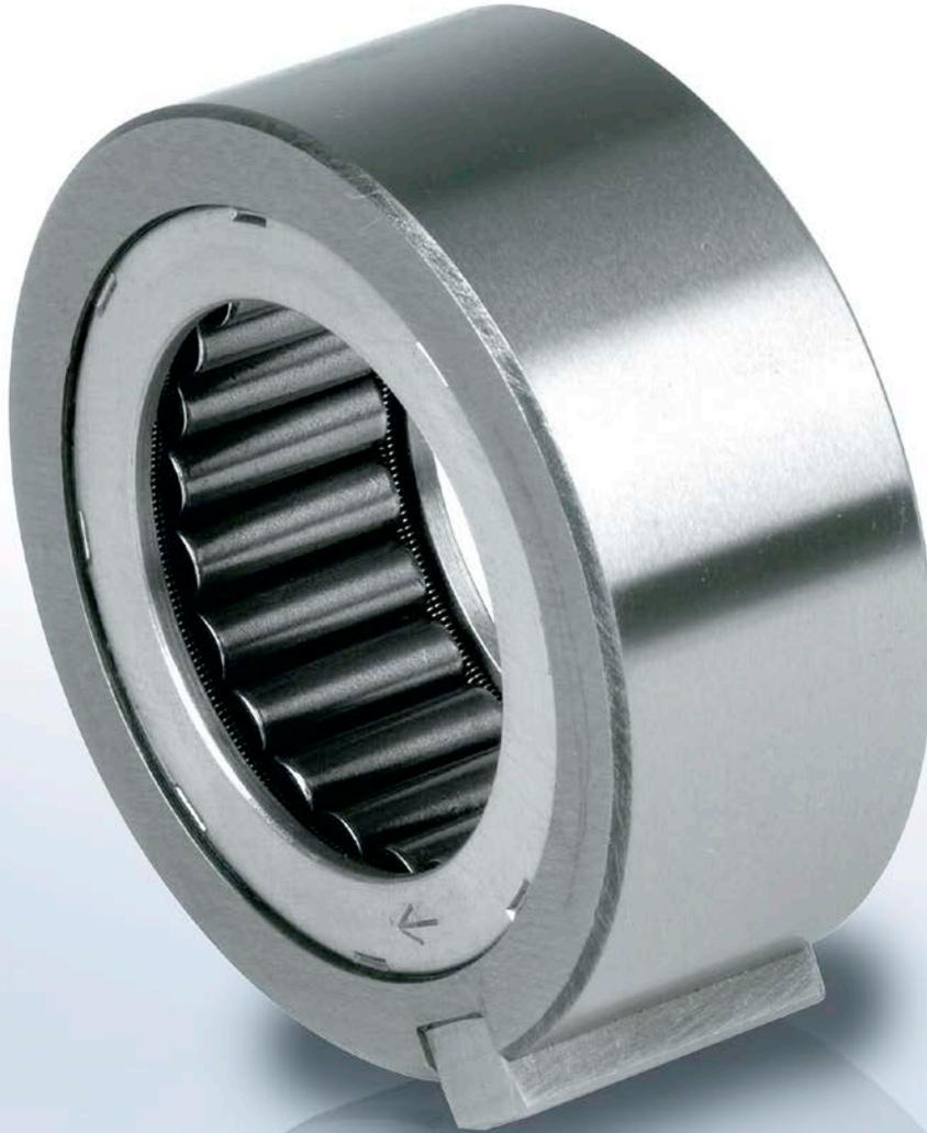
**S**200 型是一种不由轴承支撑的制轮木类型自由轮。制轮木在用户提供的机轴上直接运行。需要使用轴承支撑轴向与径向负载。安装时还必须进行润滑与密封操作。
