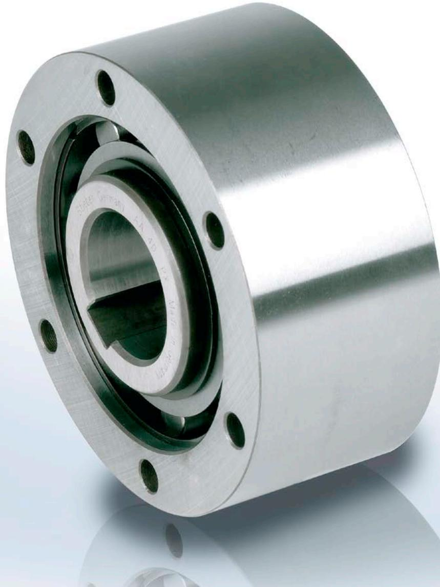
**A** A 型是一种不由轴承支撑的滚轴式自由轮。需要使用轴承支撑轴向与径向负载。安装时还必须进行润滑与密封操作。
