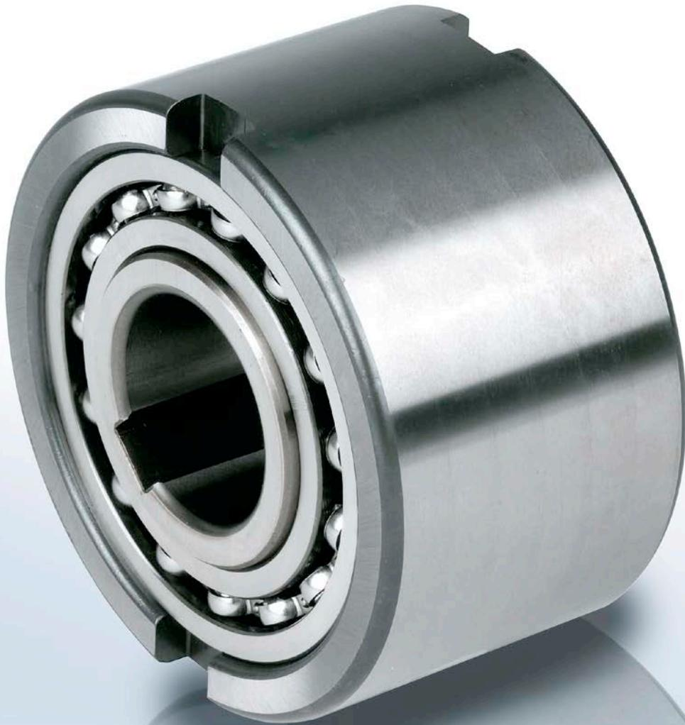
**N**FR 型是一种无任何密封件, 并且由轴承支撑的滚轴式自由轮。安装时必须进行润滑与密封处理。润滑油润滑为标准方法。
