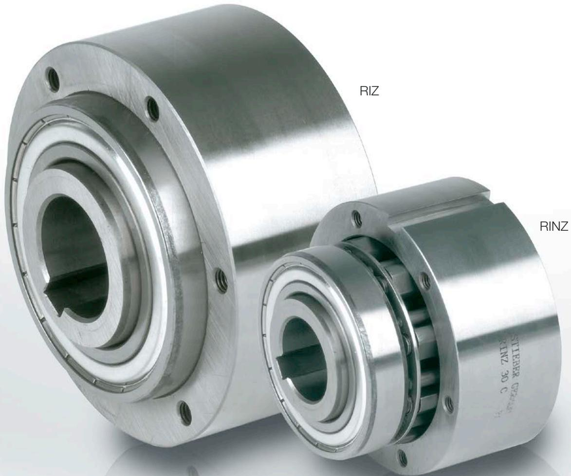
RIZ 和 RINZ 这两种型号均为带离心非接触模块的超越离合器，一般使用在内圈超越旋转的设计中，且只适用于内圈超越旋转，也常常用于逆止器的应用。
