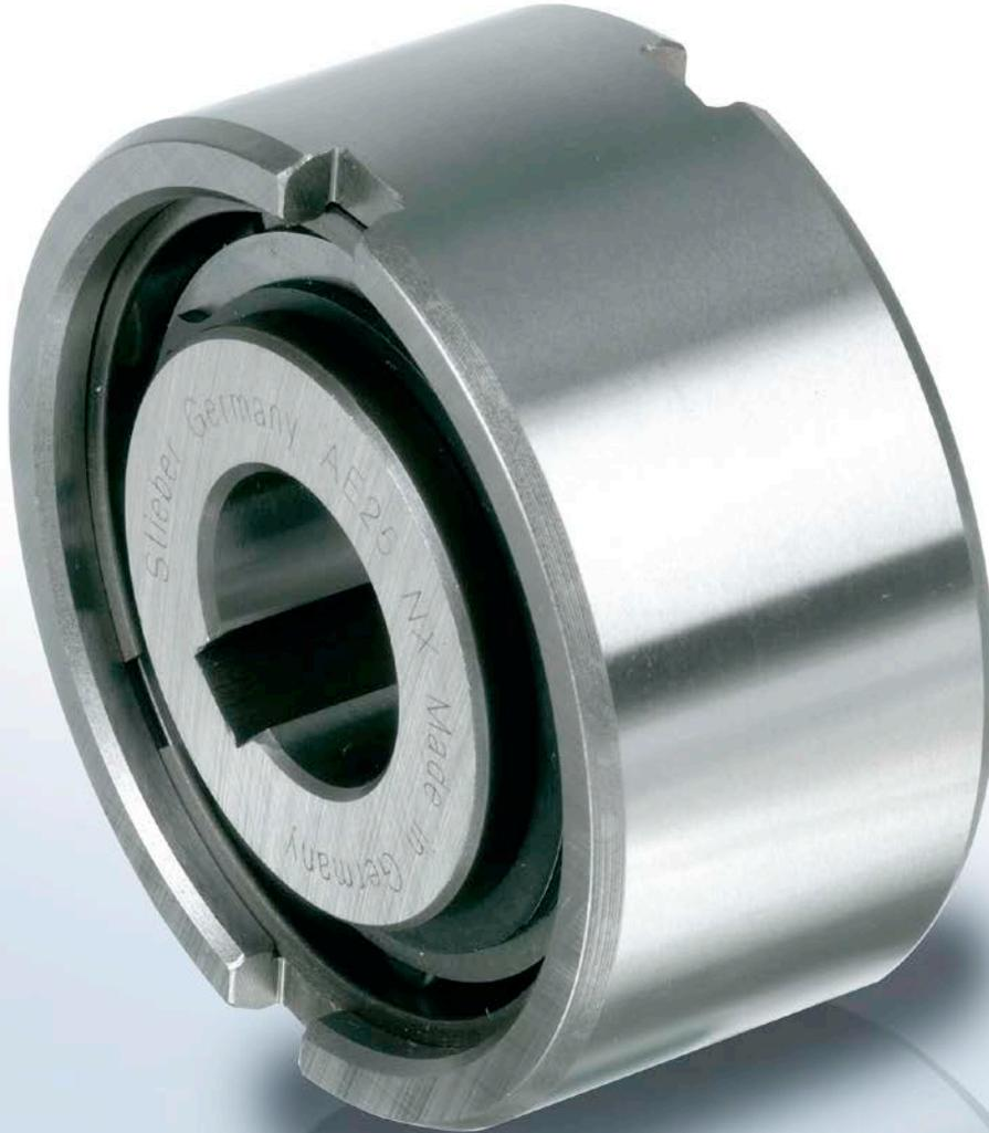
**A**E 型是一种不由轴承支撑的滚珠式自由轮。需要使用轴承支撑轴向与径向负载。安装时还必须进行润滑与密封操作。标称外径为标准滚珠轴承尺寸。
