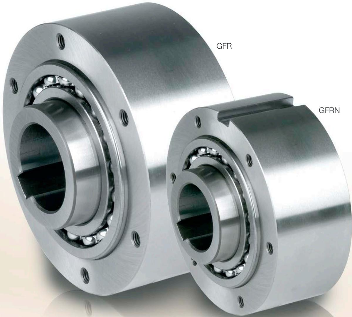
**G**FR 与 GFRN 型为滚轴式自由轮。这些装置属于 Stieber 模块化系统的组成部分。这些类型自由轮由轴承支撑, 使用两个 160.. 系列轴承, 需要使用润滑油润滑。这些装置可在提供润滑油润滑与密封功能的设计中使用(如次页示例所示)。不得对轴承轴向施加应力。
