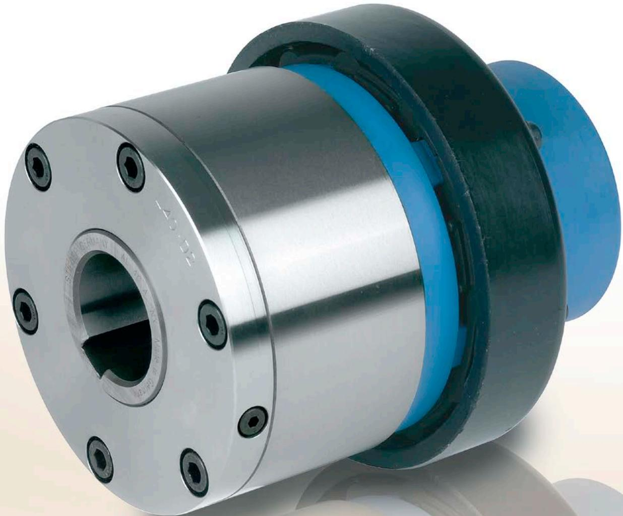
**A**L..KMSD2 型是滚轴式自由轮，独立、密封并且使用了 2 个 160.. 系列的轴承作为支撑。装置在出厂时已使用润滑油润滑。这种组合用作超越离合器（如次页所示）。
