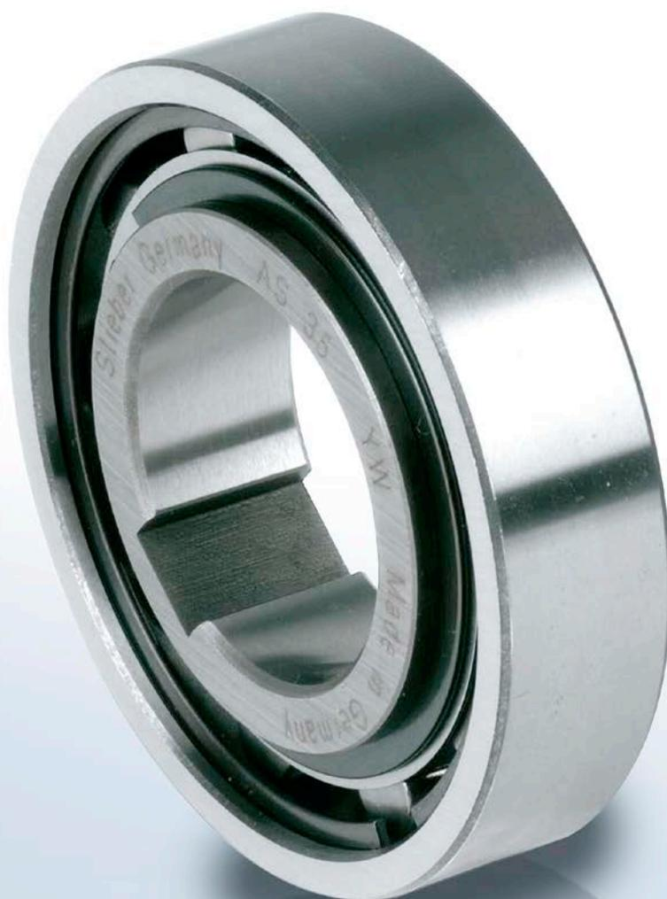
**A**S 型号为滚柱型单向离合器无轴承支撑。需要配合轴承安装以支撑轴向和径向的负载。使用者需提供润滑和密封。外形尺寸与 62 系列滚珠轴承相同。
