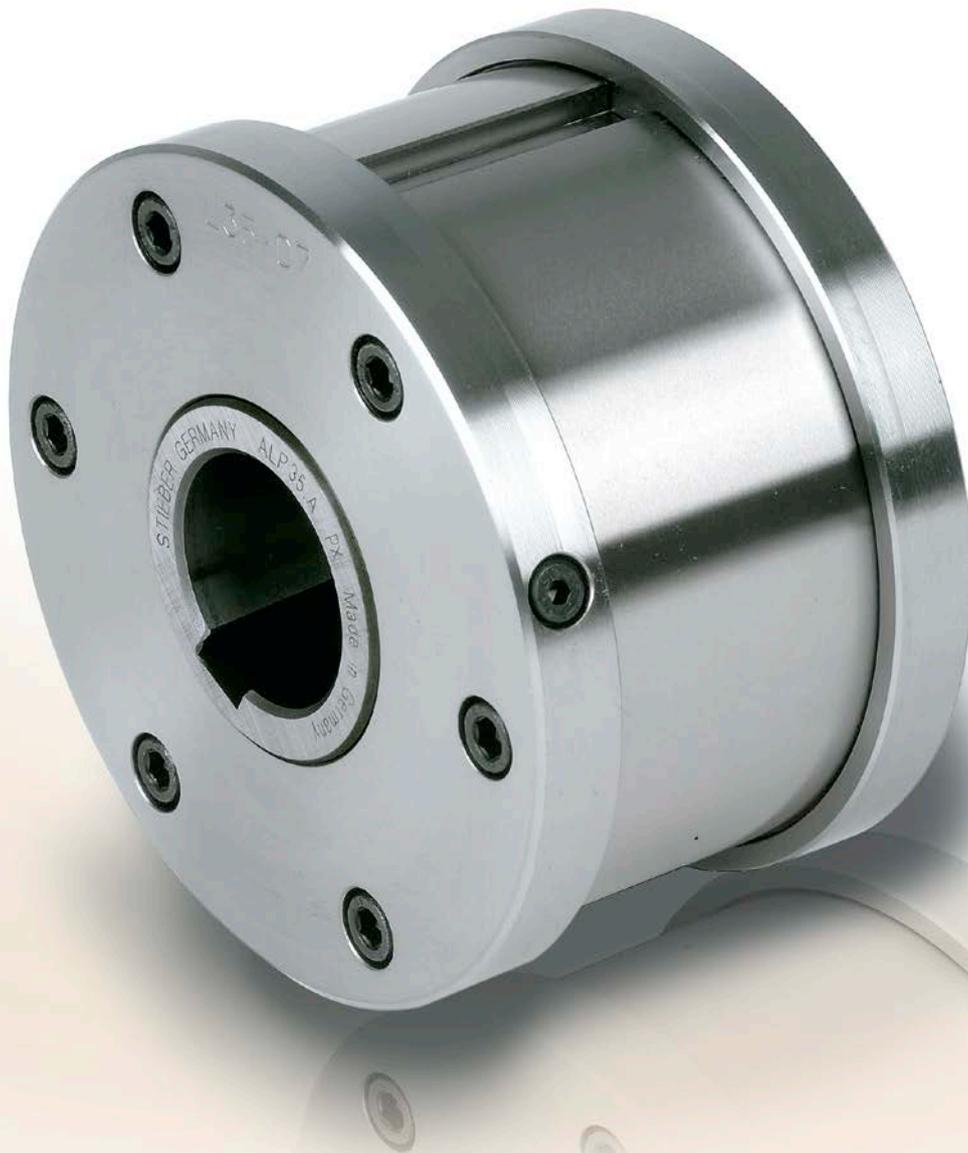
**A**LP..F7D7 型是滚轴式自由轮，独立、密封并且使用了 2 个 160.. 系列的轴承作为支撑。装置在出厂时未使用润滑油润滑。
