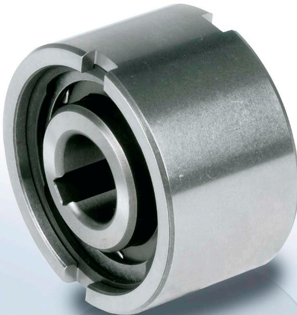
**N**F 型是一种不由轴承支撑的滚轴式自由轮。需要使用轴承支撑轴向与径向负载。安装时还必须进行润滑与密封处理。
