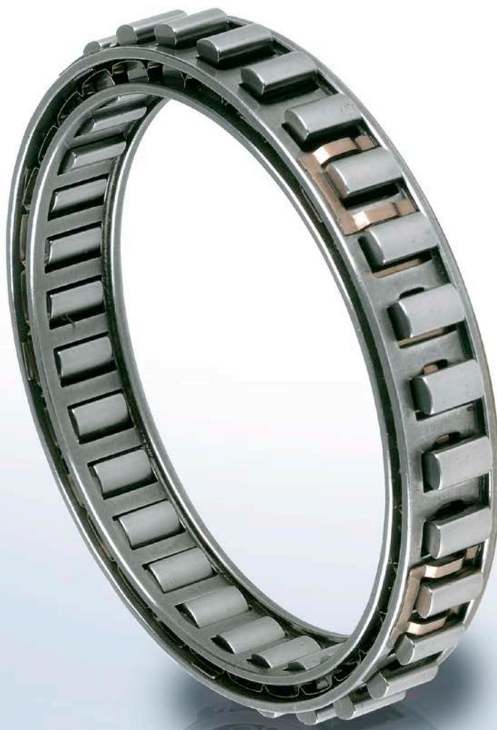
**D**C 型号为不规则形状作动子，不带内外环的单向离合器。此型号必须配合客户自行设计的内环及外环，轴承支撑轴向及径向的负载，与润滑油脂及油封。DC-N 型号可使用动力传动设备上的各种型号的润滑油。
